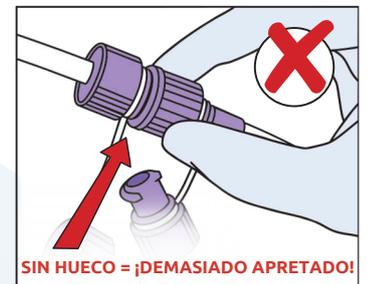
Utiliza un simple "Giro de Dos Dedos" para una conexión firme y segura, girando únicamente el conector macho móvil ENSwivel®.
